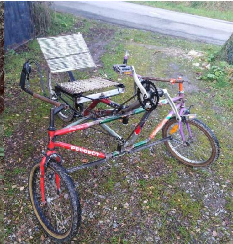
Dans l'objectif de participer aux "24h du Myons", une course de voitures à pédales en Auvergne, Paul a réalisé sa propre voiture à pédales. Après avoir réalisé les plans avec un professionnel, fait un stage dans une association de réparation de vélos où il a acquis de nombreuses compétences en mécanique, il a procédé à la construction de sa voiture à pédales, utilisant un maximum de matériel de récupération.
